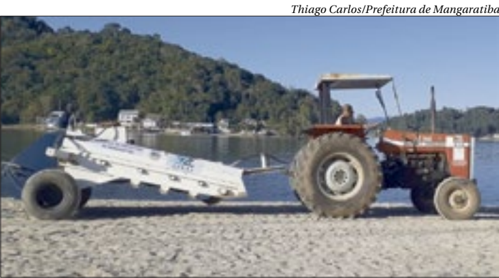
A máquina, que é puxada por um trator, retira todo o lixo das areias
