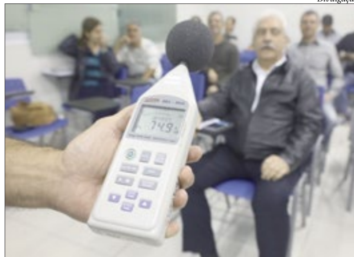
Funcionários aprendem a usar o sonômetro, aparelho que capta os sons
